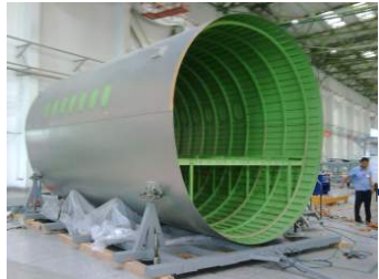
Cylindre d'essai du fuselage de 23 pieds en Al-Li
